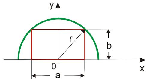
d) Aus einem kreisförmigen Baumstamm mit dem Durchmesser  $d$  soll ein Balken mit rechteckigem Querschnitt herausgeschnitten werden, der maximale Tragfähigkeit besitzt. Die Tragfähigkeit eines Balkens sei durch  $T = cxy^2$  gegeben, wobei  $x$  die Breite,  $y$  die Höhe und  $c > 0$  die Materialkonstante des Balkens angibt. Wie müssen  $x$  und  $y$  gewählt werden, um maximale Tragfähigkeit zu erreichen?
