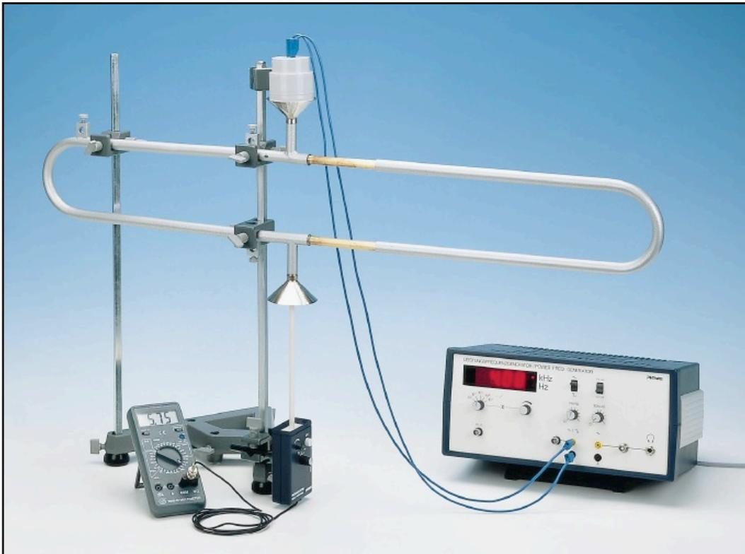
**Abbildung 1:** Experimenteller Aufbau zur Bestimmung der Wellenlänge von Schallwellen mit einer Quincke Röhre.
