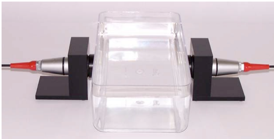
Abbildung 7: Probenwanne gefüllt mit Wasser und in Querrichtung angekoppelte Schallwandler.
