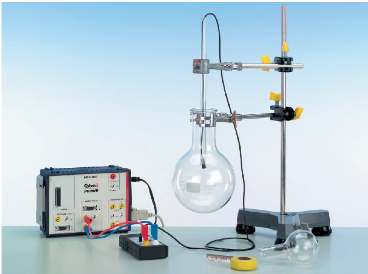
Abbildung 1: Experimenteller Aufbau zur Ermittlung charakteristischer Resonanzfrequenzen
