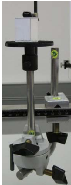
Abb. 3: Detail zur Halterung des Prismentisches
