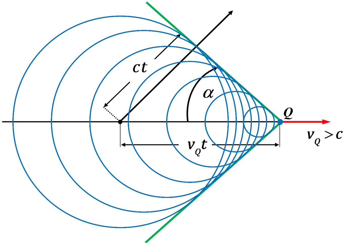
Da sich die Wellenfront auf dem Kegelmantel konstruktiv addieren, hört ein von der kegelförmigen Wellenfront getroffener Beobachter einen explosionsartigen Knall.
