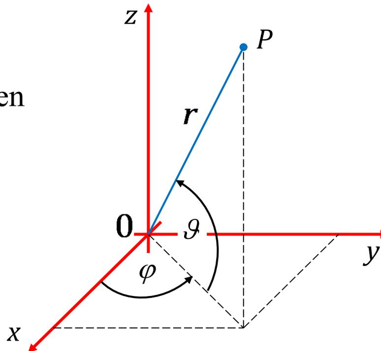
Im Ursprung des Koordinatensystems befinde sich eine Schallquelle verschwindend kleiner Ausdehnung. Von dort wird der Schall omnidirektional abgestrahlt. Die Schallfeldgrößen, z.B. der Druck, hängen nur von der Entfernung  $r$ , nicht aber vom Azimut  $\varphi$  und von der Elevation  $\vartheta$  ab.
