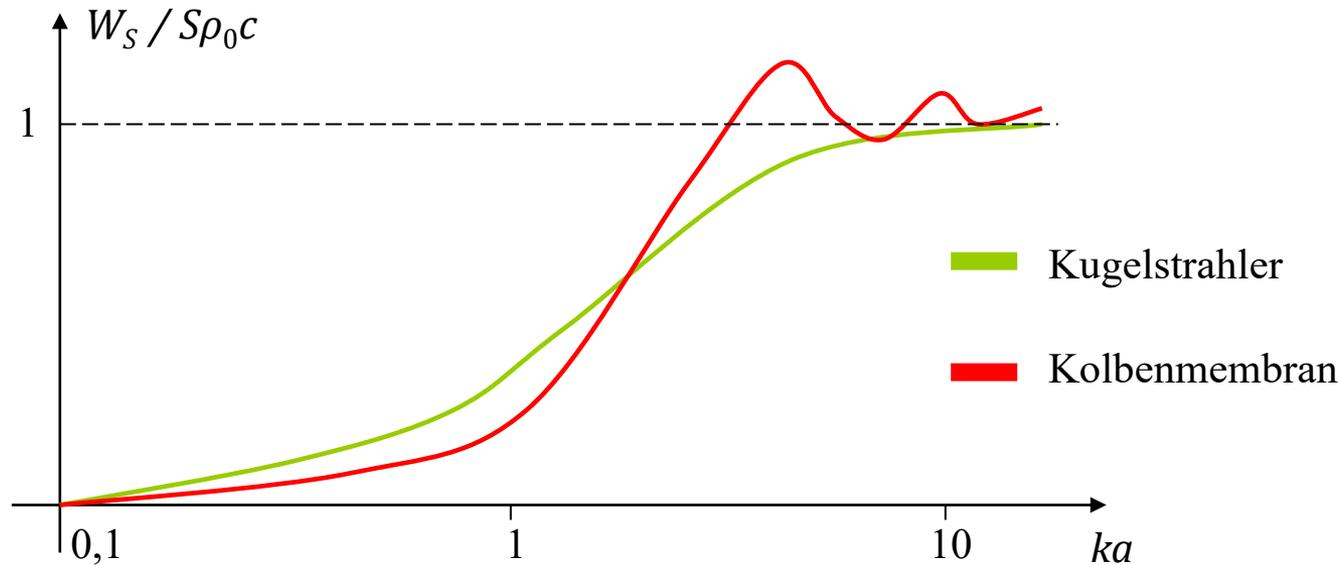
Bei tiefen Frequenzen wird überwiegend Mediummasse hin- und her bewegt, was wirkleistungslos und ohne Schallabstrahlung erfolgt.
